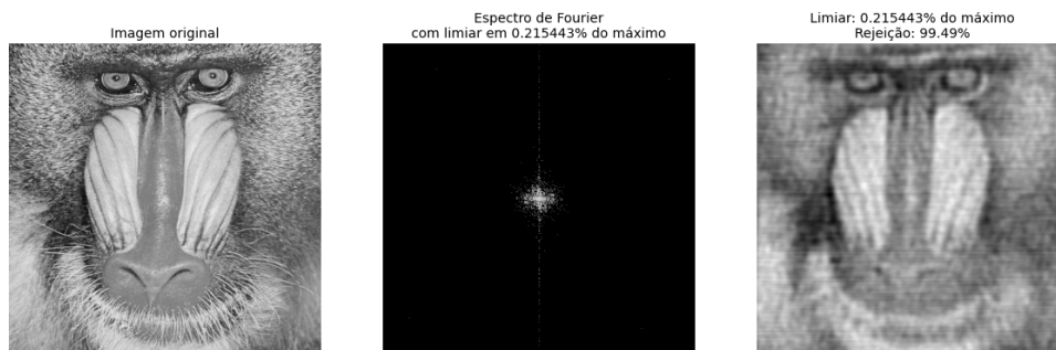
Figura 6: Imagem, espectros de Fourier (em preto, pontos abaixo do limiar) e imagem resultante.
