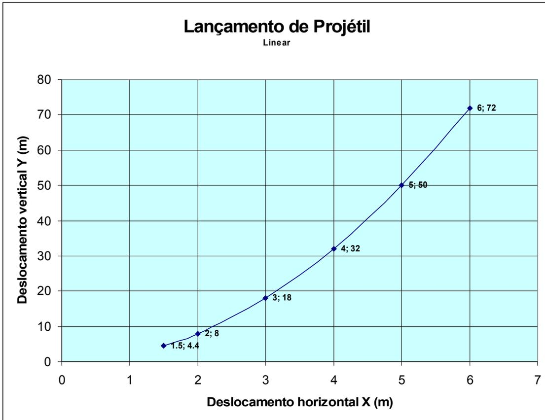
Logo, observando o gráfico podemos inferir que a relação matemática entre as variáveis, altura percorrida ( $y$ ) e deslocamento na horizontal ( $x$ ), é do tipo potência:  $y = kx^a$ . Portanto, para poder determinar os parâmetros  $k$  e  $a$  é preciso linearizar o gráfico acima. Desta forma passamos o gráfico para o papel di-log
