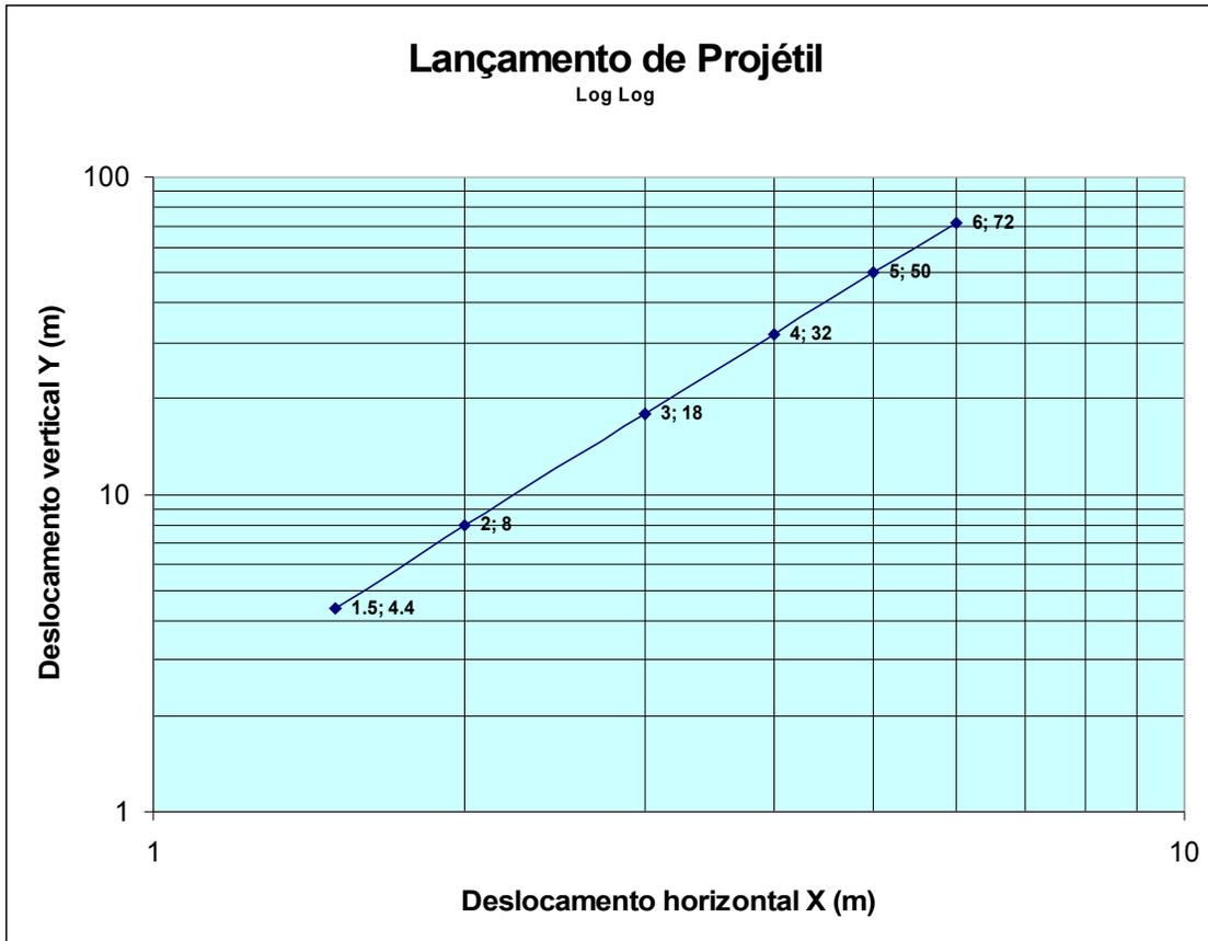
b) Para a construção do gráfico no papel di-log basta passarmos os pontos da tabela diretamente para o gráfico e a partir dele se obtém uma relação linear entre  $\text{Log } y$  e  $\text{Log } x$ .
