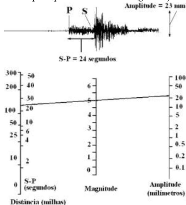
(23mm) no sismograma Wood-Anderson do trem de ondas geradas por sismo marcam dois pontos n as escalas externas do monograma. Conectando estes dois pontos encontra-se a magnitude do sismo = 5.0. Cada acréscimo no grau da escala de magnitude representa um aumento de 10 vezes na medida da amplitude de uma onda e um incremento aproximado de 32 vezes da energia sísmica liberada.
